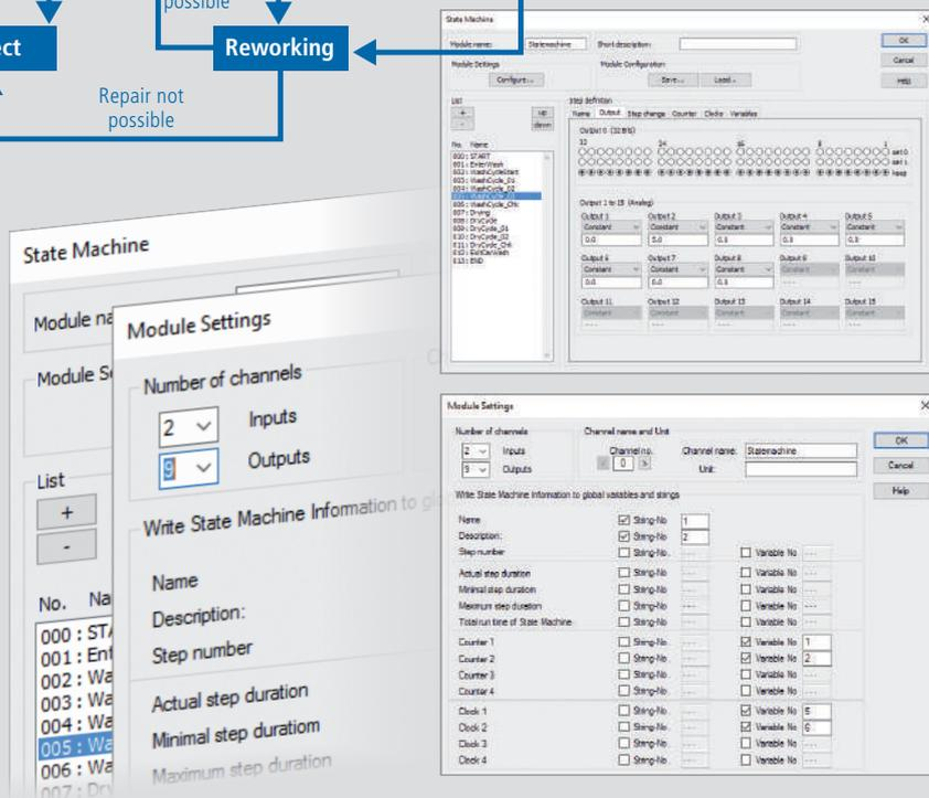
DASYLabのステップシーケンスの従来のセットアップでは、ある時点では実は不要なステップシーケンス部分も含め、すべてのモジュールが常に並行して同時に処理されます。これに対して、ステートマシンモジュールでは、ステップシーケンスの有効部分のみが処理されます。これは、作業ステップに関するすべての決定がモジュール単独で行われるためです。これにより、処理時間と必要メモリが大幅に削減されます。
